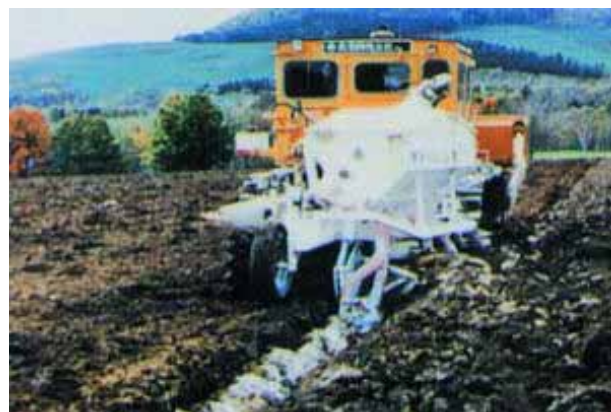
心土破碎と同時に土壌改良資材を投入
